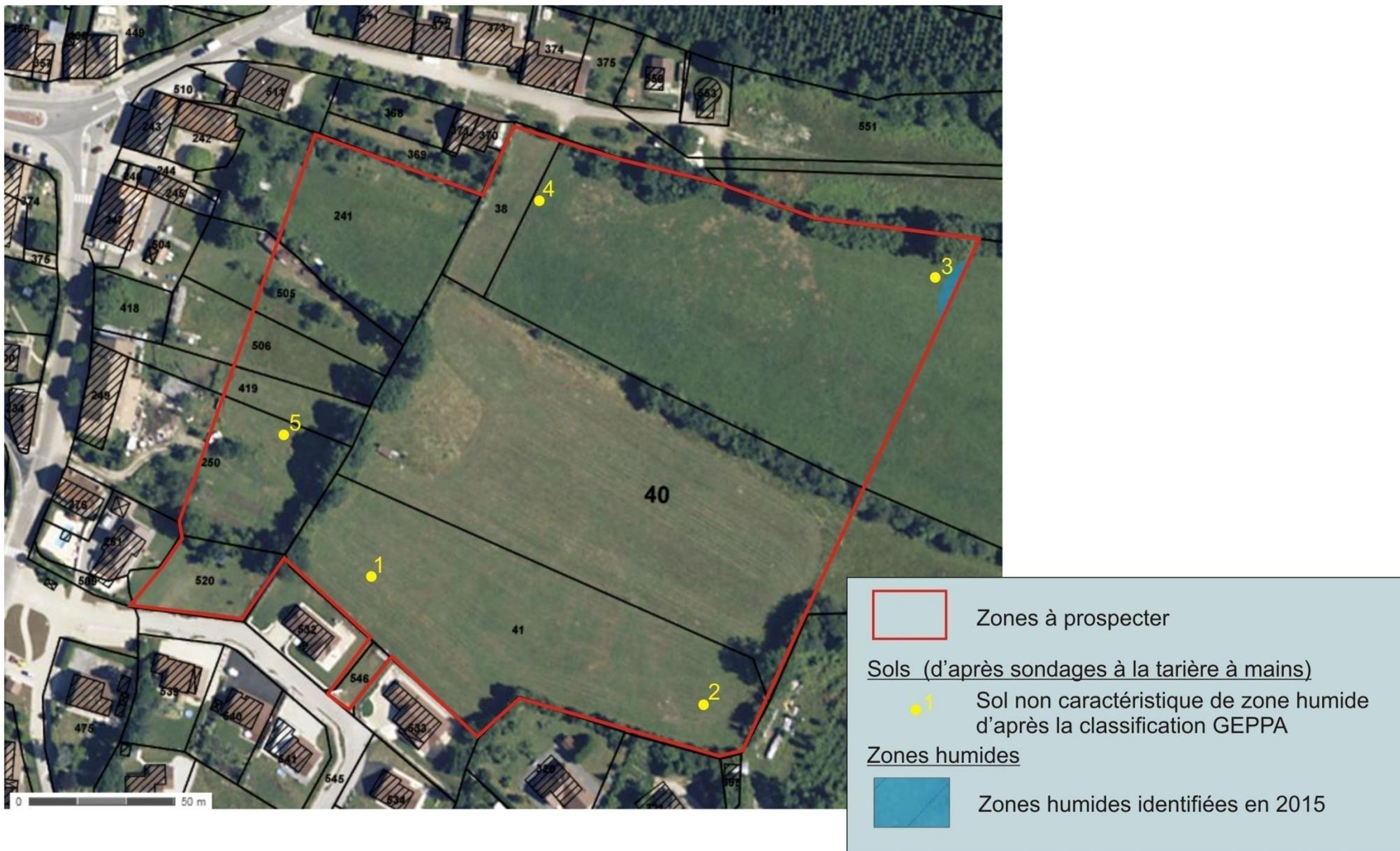
Figure 4 : Cartographie des sondages pédologiques réalisés au cours de l'étude sur le site
