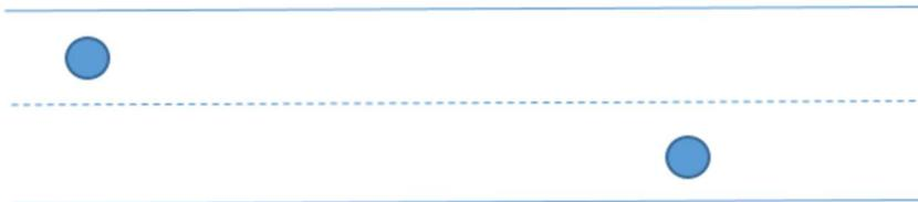
Figure 6: Emplacement préférentiel des regards par rapport à la circulation
